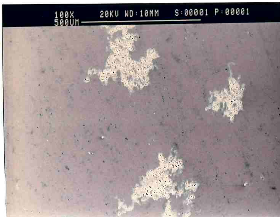
Fotografia 4: Imagem obtida em microscópio eletrônico de varredura. Amostra 1, E= -754 mV, aumento de 100x. As partes mais claras são regiões de corrosão localizada. Nota-se que essas regiões aparecem dispersas na matriz.
