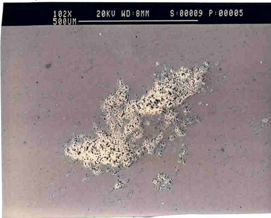
Fotografia 6: Imagem obtida em microscópio eletrônico de varredura. Amostra 9, polimento 1 micron, E = -714 mV, aumento de 100x. As partes mais claras são regiões de corrosão localizada. Nota-se que essas regiões aparecem dispersas na matriz e em menor quantidade que na fotografia 4.
