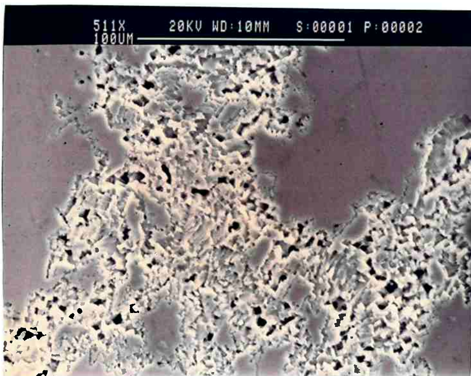
Fotografia 7: Imagem obtida em microscópio eletrônico de varredura. Amostra 1, Lixa #600, E = -754 mV, aumento de 500x. As partes mais claras são regiões de corrosão localizada. Nota-se claramente a diferença de tonalidade entre a região corroída (mais clara) e a matriz de alumínio (mais escura). Na região corroída as partes negras são buracos e as brancas são produtos de corrosão depositados.
