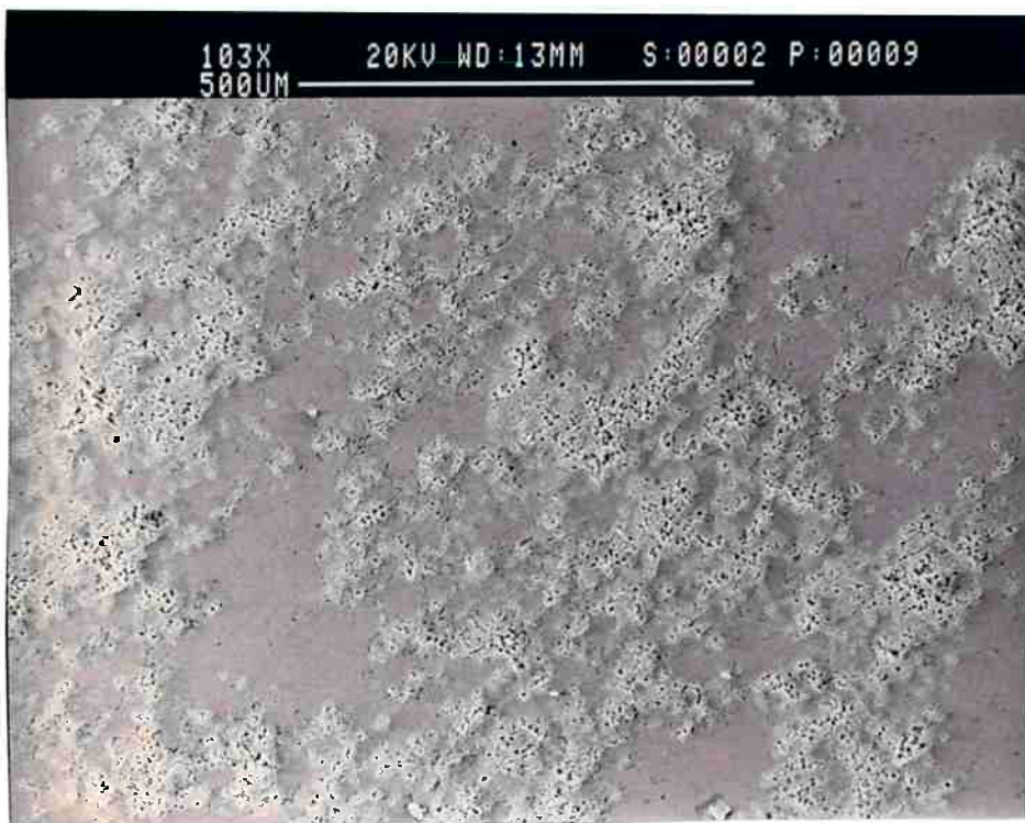
Fotografia 5: Imagem obtida em microscópio eletrônico de varredura. Amostra 2, Lixa #600, E= -714 mV, aumento de 100x. Nota-se que nesta amostra a região corroída ocupa quase a totalidade da superfície da amostra.
